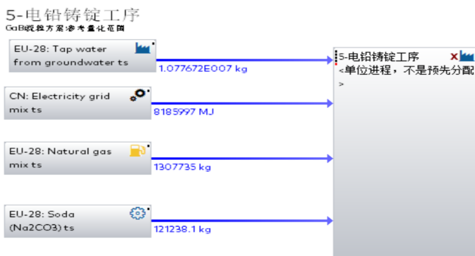
图 3.5 电解铅铸锭阶段 GaBi 模型
