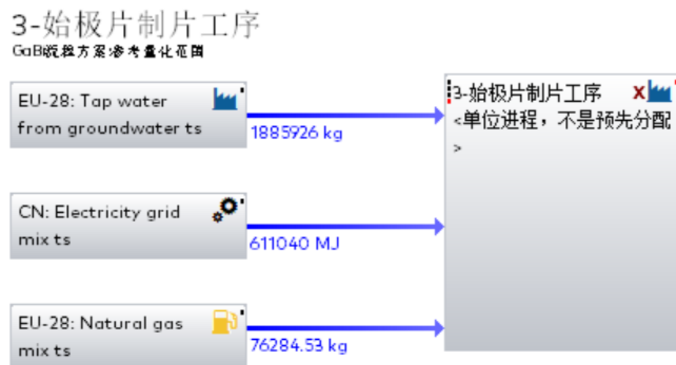
图 3.3 始极片制片阶段 GaBi 模型
