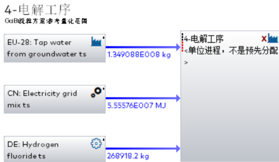
图 3.4 电解阶段 GaBi 模型
